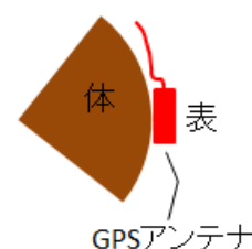
図②：GPSアンテナの表が常に表面にでているように装着する
